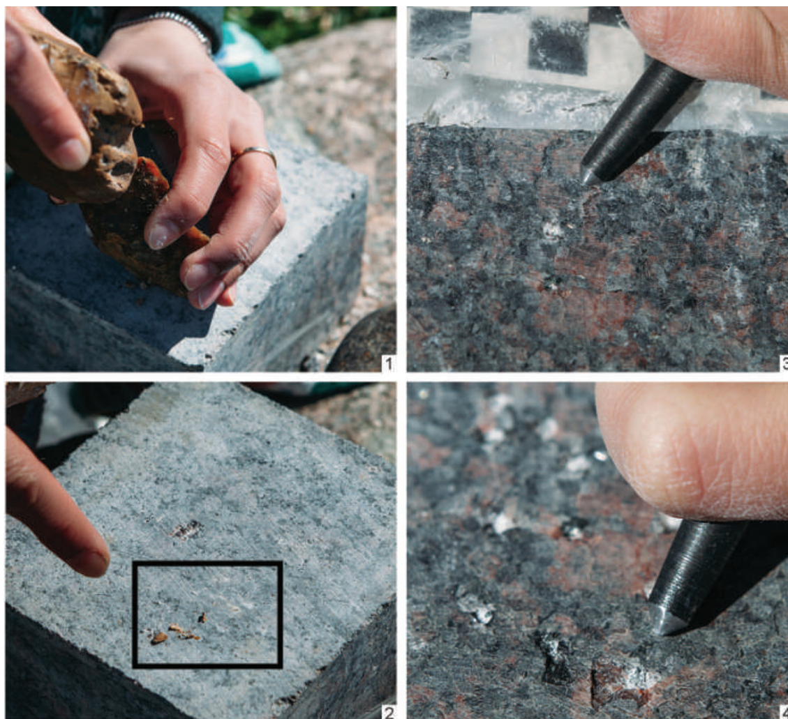
Рис. 2. Эксперименты: 1, 2 — «кремень по граниту»; 3, 4 — «сталь по граниту»
