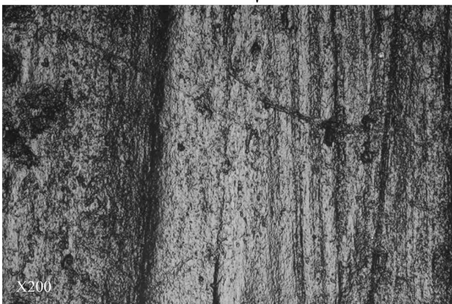
Рис. 44. Процесс накидного вычёсывания волокон крапивы (изготовление веревок) на наборном карде с костяными зубцами (табл. 3) — 1–3; кард после работы — 4; зубец карда после работы — 5; микрофотографии следов износа на поверхности зубца карда ( \times 100 , 200) — 6–9
