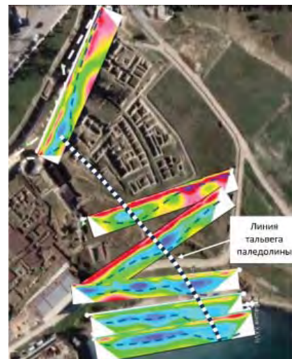
Рис. 12. Сводная карта комплексных сейсмоэлектротомографических разрезов в пределах городища и прибрежной территории Херсонеса с указанием линии тальвега палеодолины
