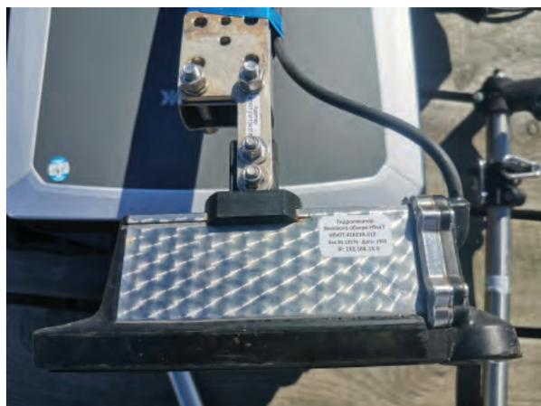
Рис. 12. Гидролокатор бокового обзора H5se7
