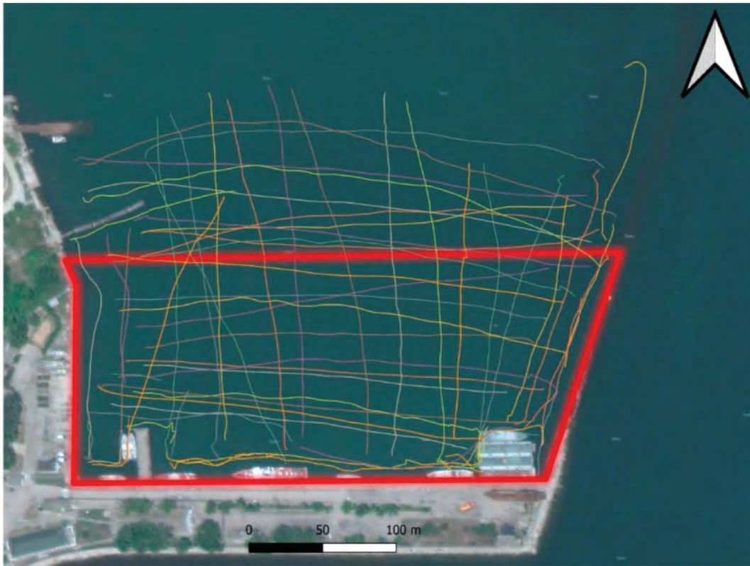
Рис. 13 Лини фактического движения носителя при проведении съемки гидролокатором бокового обзора
