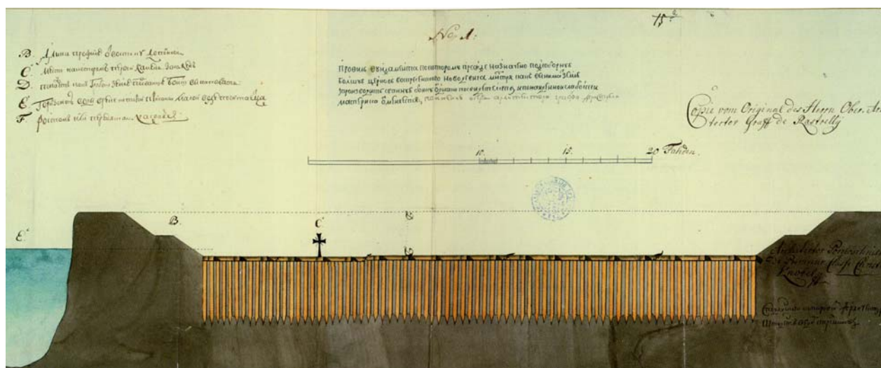
Рис. 13. Профиль фундамента, на котором был заложен камень для строительства Смольного собора. Чертёж 1748 г.
