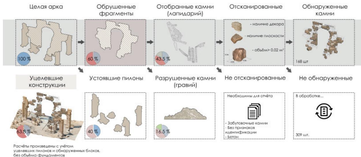
Рис. 28. Анализ данных в программе по BIM-проектированию
