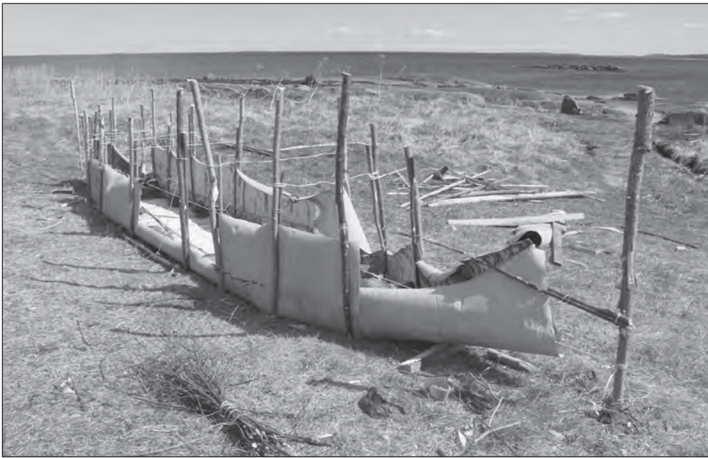
Рис. 6. «Морская» берестяная лодка в процессе «пришивания» бортов к днищу
