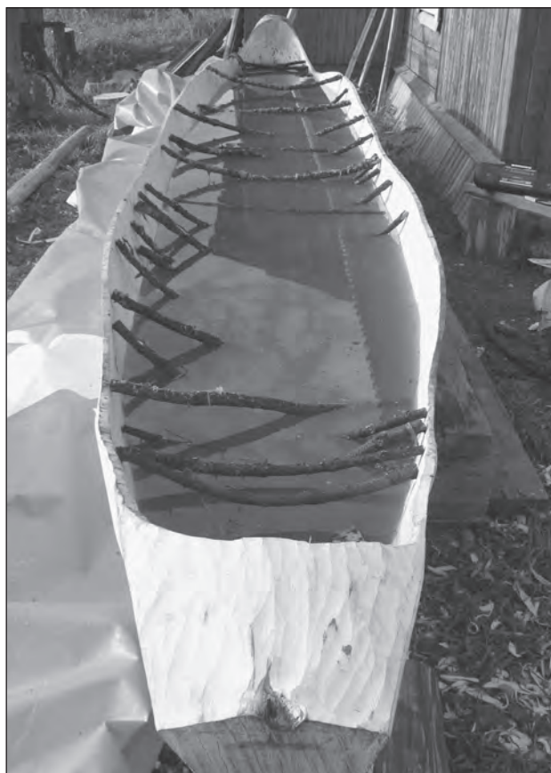
Рис. 11. Строительство лодки-долблѐнки (разводка бортов)
