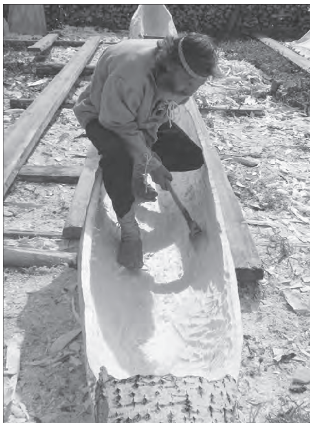
Рис. 10. Изготовление «морской» лодки-долблѐнки (выдалбливание). На снимке А.А. Казаков
