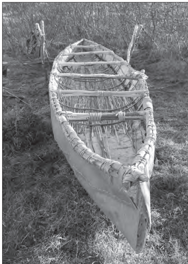
Рис. 7. Лодка после закрепления бортов на «раме» и прокладки стрингеров
