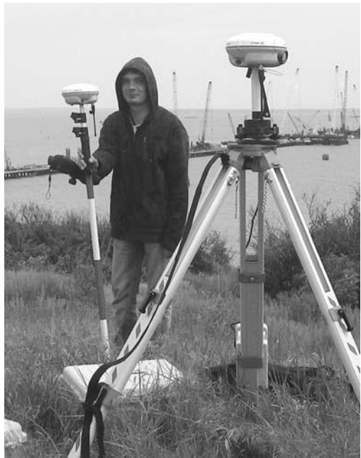
Рис. 62. Геодезические измерения с помощью дифференциального GPS приемника TRIMBLE R8. Оператор А. Н. Гаврилюк. Фото Т. Н. Смекаловой
