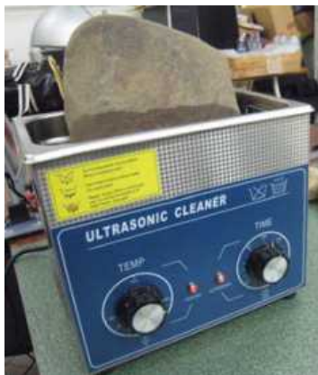
Рис. 8. Процесс смывки крахмала с поверхности орудия в ультразвуковой ванне
