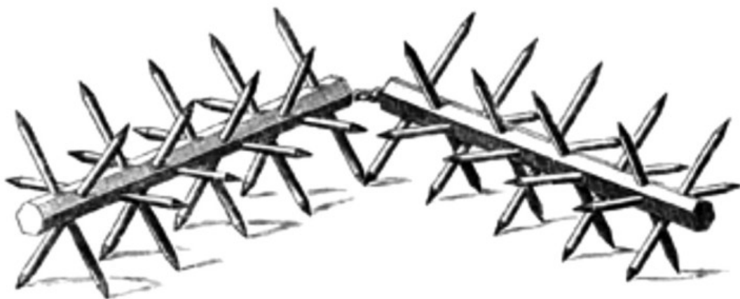
Рис. 2. «Испанские рогатки», собранные из полупик и продольных граненых брусьев с крестообразными сквозными отверстиями. Фрагмент гравюры Генри Хексэма (Henry Hexham), 1642 г. (по: De Groot 2017)
