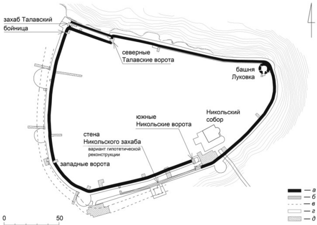
Рис. 7. Реконструкция плана Изборской крепости. Первоначальная крепость в системе сооружений последующих этапов: а — крепостные сооружения 1-го строительного этапа; б — гипотетическая реконструкция; в — зона крепостного рва 1-го строительного этапа; г — крепостные сооружения в XV–XIX вв.; д — археологические раскопы 2000–2013 гг., связанные с исследованием первоначального строительного этапа крепости
