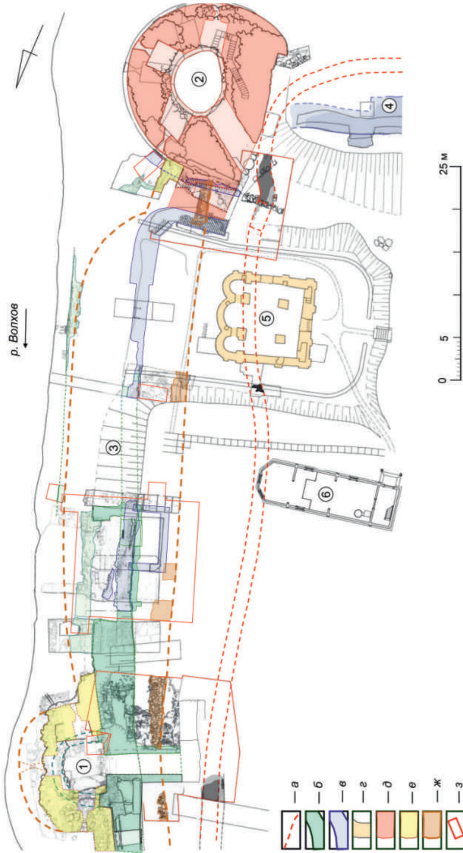
Рис. 2.26. Старая Ладога, крепость. Периодизация укреплений юго-восточного прясла. Цифрами обозначены: 1 — Тайничная башня; 2 — Раскатная башня; 3 — юго-восточное прясло; 4 — южное прясло; 5 — церковь Георгия; 6 — церковь Дмитрия Солунского. Условные обозначения: а — трассировка крепостной стены X–XI вв.; б — крепостные стены 1114 г.; в — крепостные стены второй половины XII в.; г — строительство церкви Георгия (вторая половина XII в.); д — строительство каменных башен (1445 г.); е — возведение Тайничной башни и прикладов (1580-е гг.); ж — устройство земляной стены (1580-е гг.); з — археологические раскопы и шурфы 2014–2019 гг.
