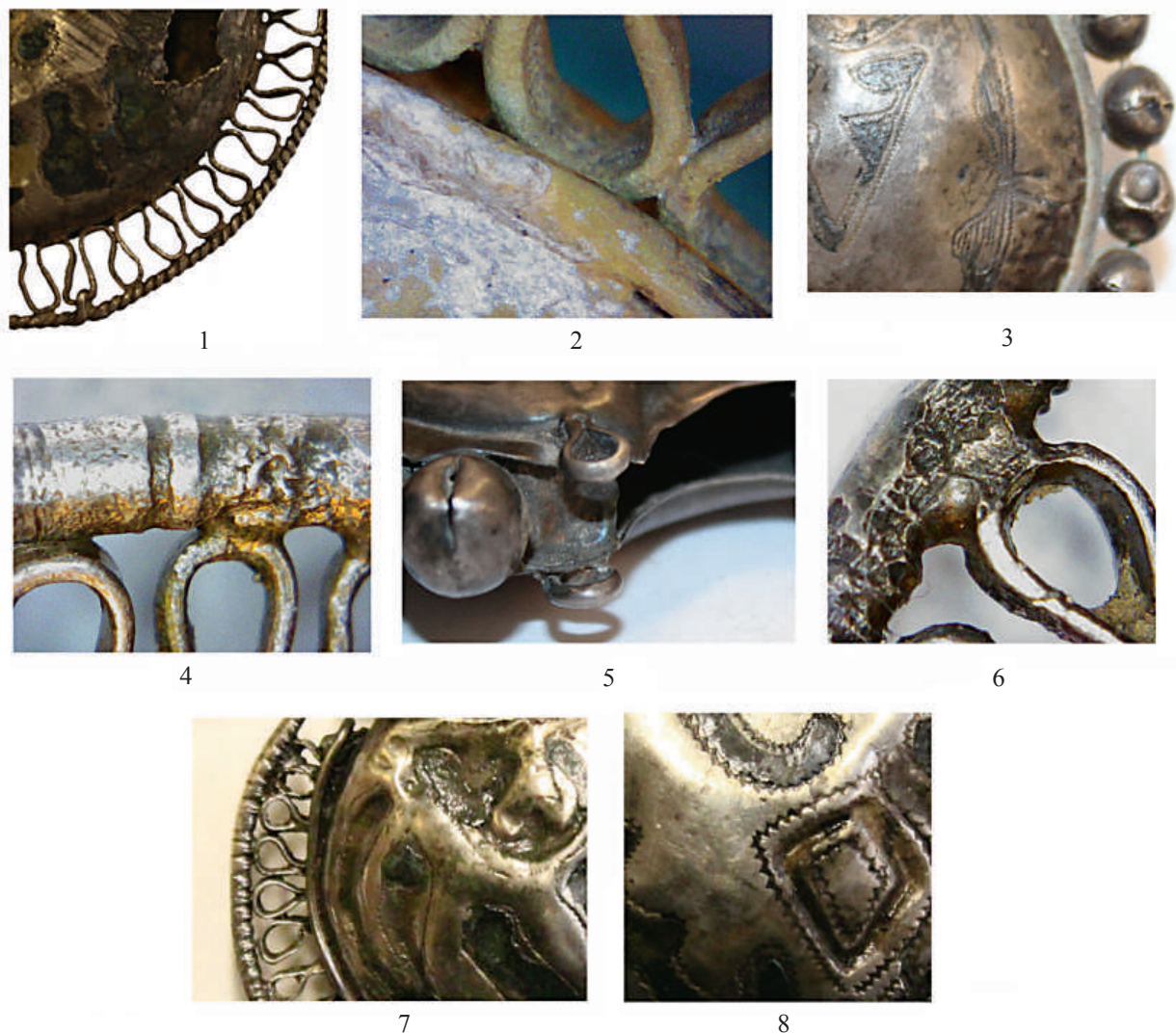
Рис. 4. Детали колтов со следами технологических операций: 1 – ЭРА.34-17; 2 – ЭРА.34-117; 3 – ЭРА.34-271; 4 – ЭРА.34-243; 5 – ЭРА.34-234; 6-7 – ЭРА.34-244; 8 – ЭРА.34-1916. Фото А. И. Корниенко
