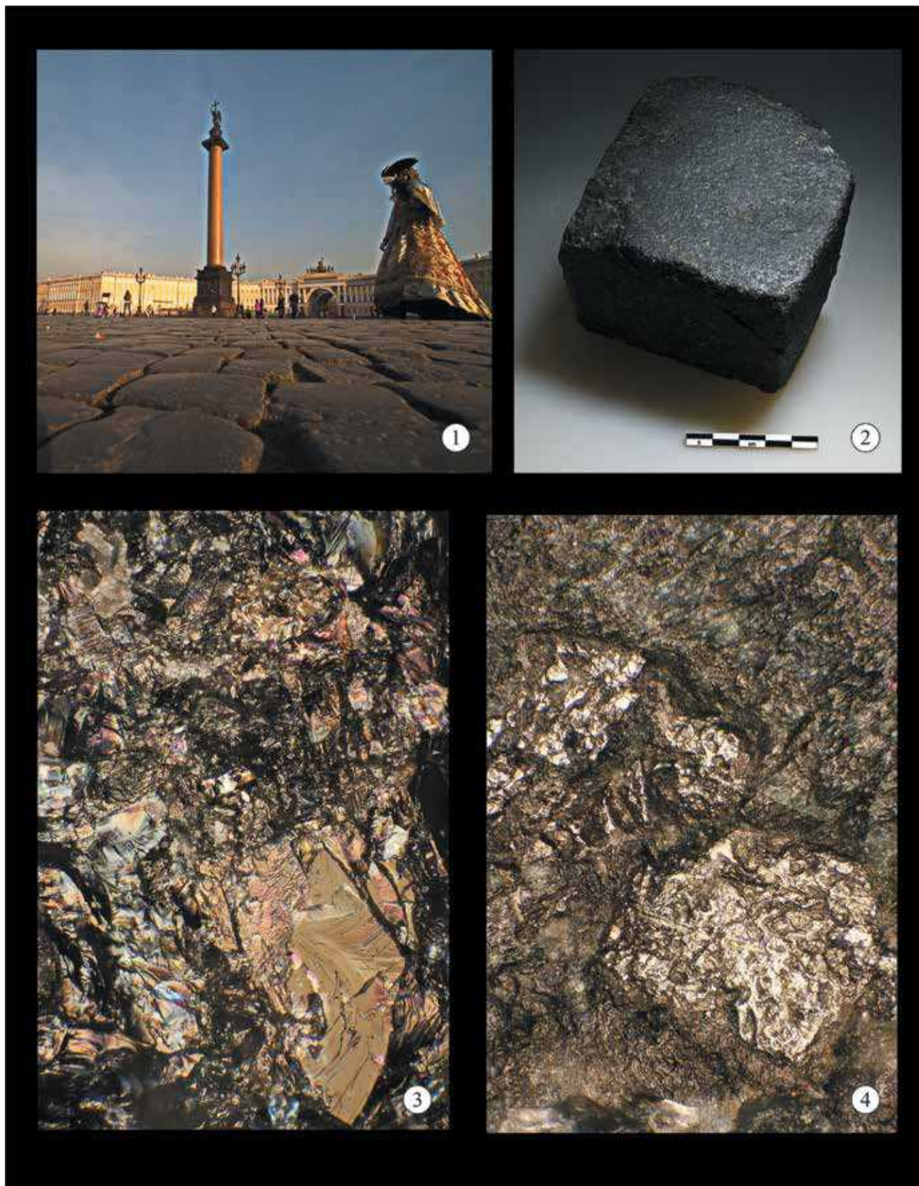
Рис. 8. Следы износа поверхности диабазовой брусчатки на Дворцовой площади. Санкт-Петербург. 1 — диабазовая брусчатка. 2 — камень из диабазовой брусчатки с изношенной поверхностью. 3 — исходная поверхность (поверхность скола на диабазовом блоке со «свежими» кристаллами плагиоклаза), увеличение X100. 4 — изношенная поверхность диабазового блока с видоизмененными истиранием кристаллами плагиоклаза. Увеличение X200.
