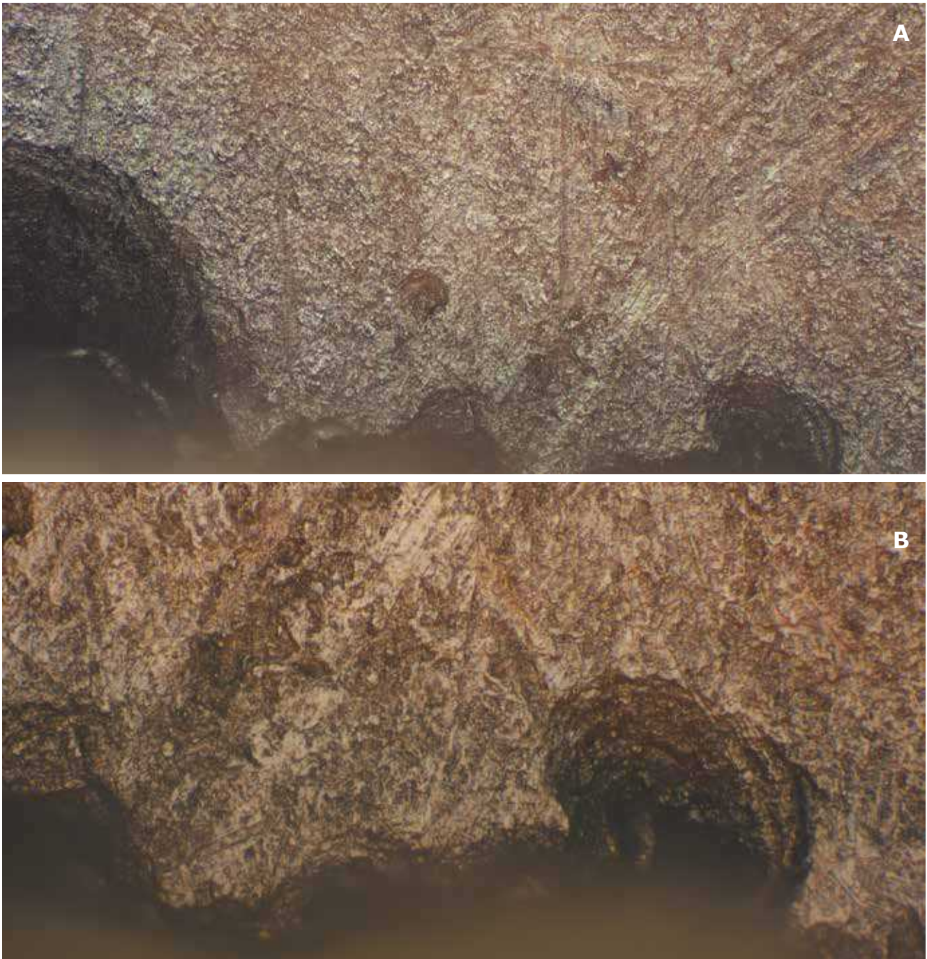
Рис. 1. А — Следы на орудии для рубки льда (пешня). Время работы 2 часа. Увеличение X200. В — Следы на орудии для рубки льда (пешня). Время работы 1 час 40 мин. Увеличение X100.
