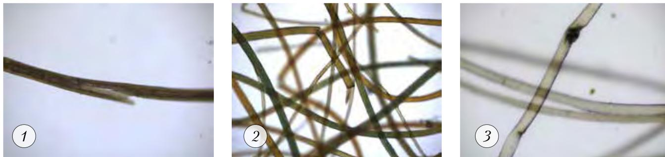
Рис. 23. Повреждения волокон: 1 – продольные изломы; 2 – поперечные изломы; 3 – повреждения боковой поверхности.
