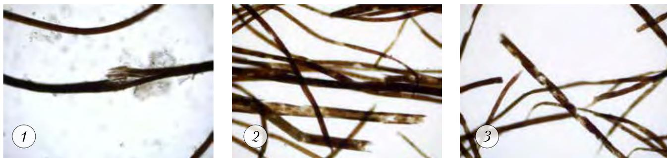
Рис. 24. Биоповреждения волокон: 1 – разрыв волокна; 2 – повреждение внутреннего объема волокна; 3 – повреждения поверхности – прогрызы.
