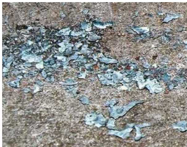
Рис. 1.3.16. «Осколки» от железа при отделении его от шлака молотком (по: H. Föll. Iron, Steel and Swords script. URL: www.tf.unikiel.de/matwis/amat/iss/index.html ; дата обращения: 08.08.2021)
