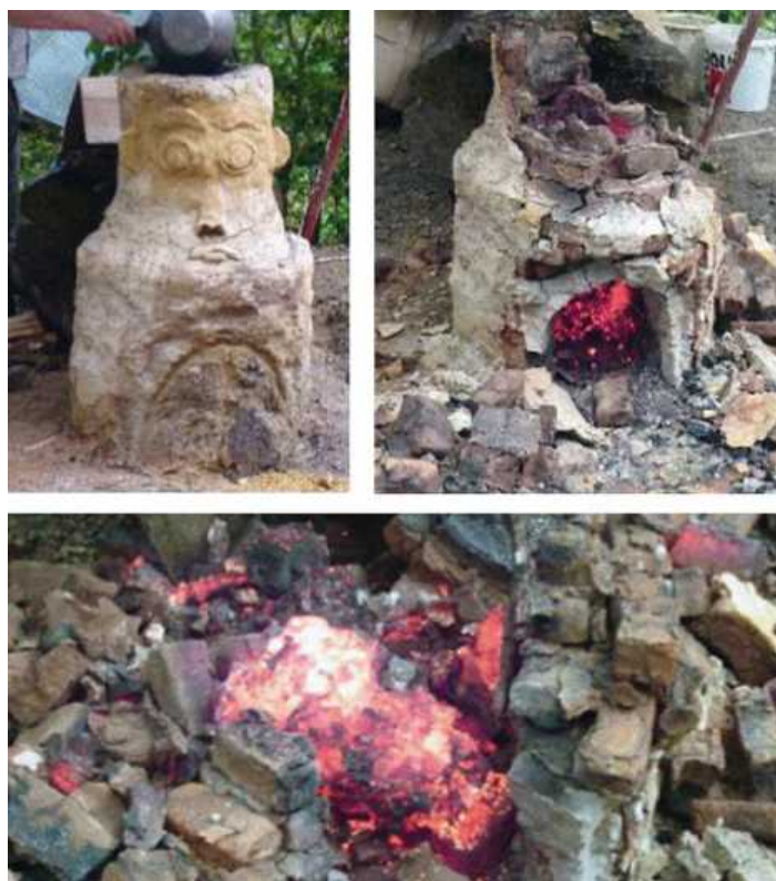
Рис. 1.3.13. Экспериментальное получение кричного железа (по: Birch et al. 2013. URL: www.tf.unikel.de/matwis/amat/iss/index.html ; дата обращения: 08.08.2021)
