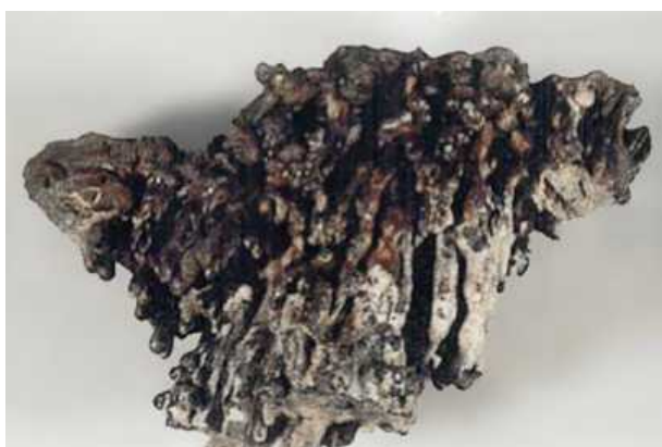
Рис. 1.3.15. Шлак, который образуется внутри печи (Сенегал), 1995 г. (по: Fluzin 2004)
