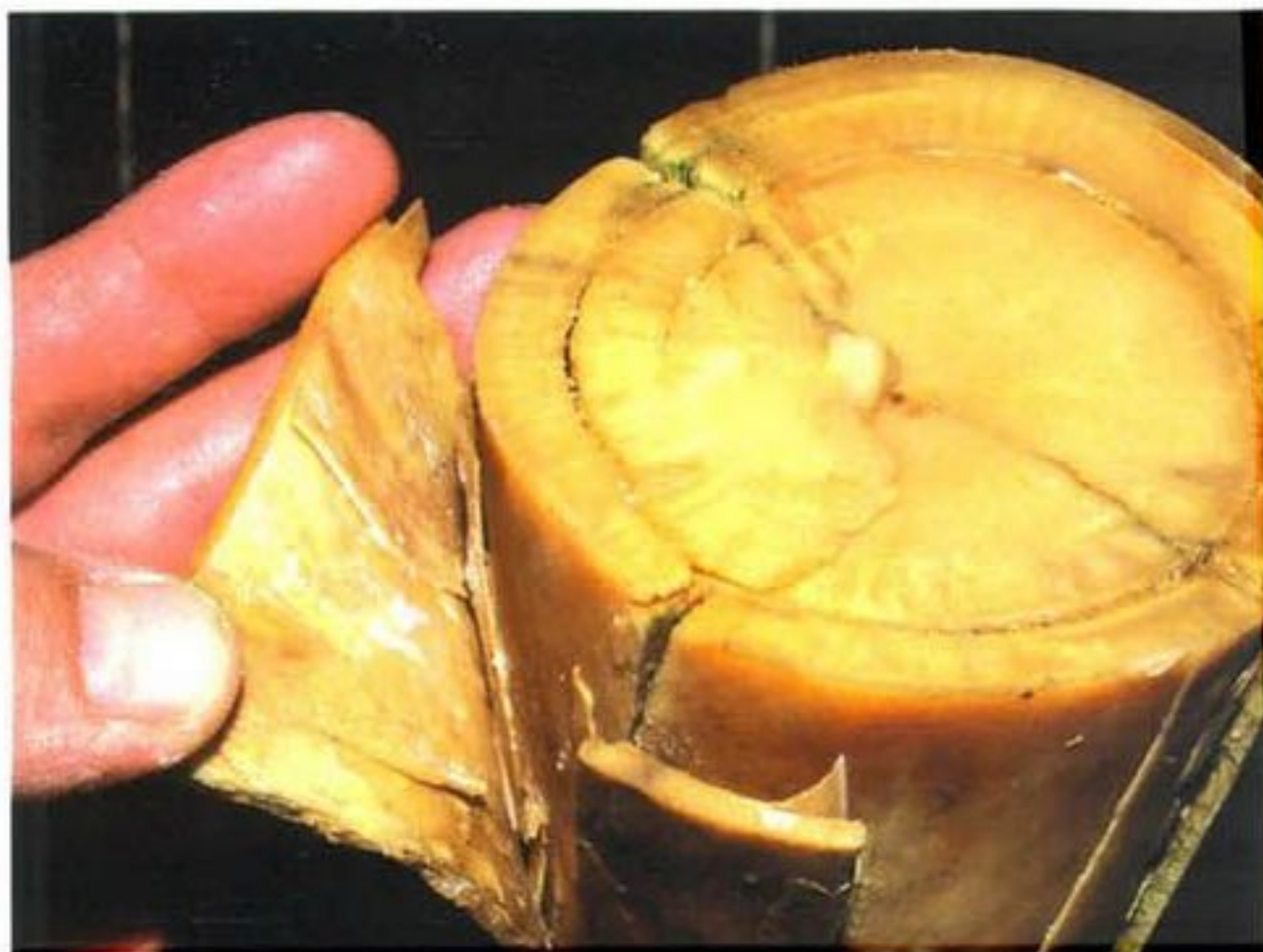
Рис. 105. Качественное состояние «свежего» трещиноватого бивня мамонта после размачивания в воде в течении 7 дней
