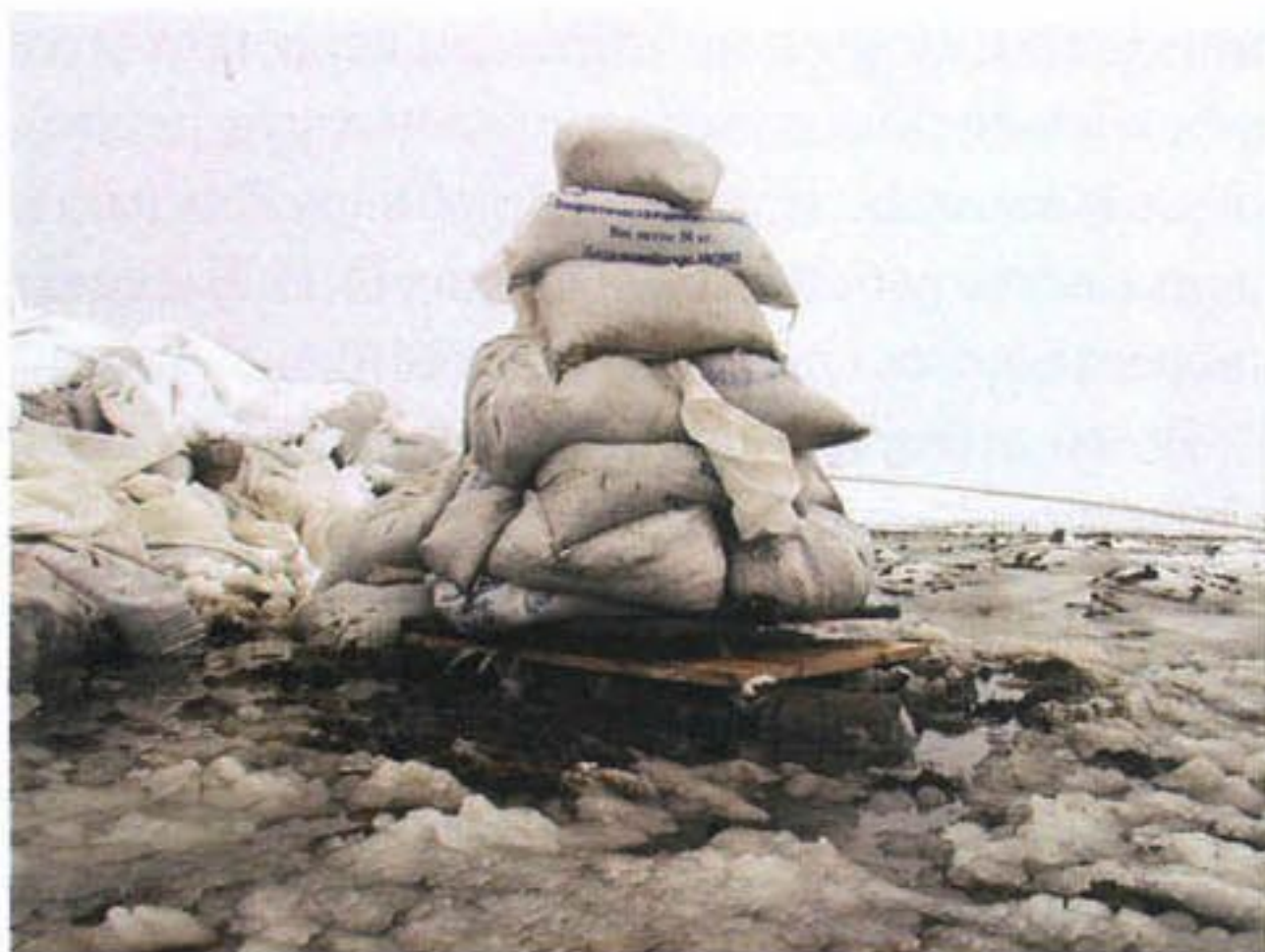
Рис. 90. Распрямление цельного рога северного оленя (нагрузка около 2 т)
