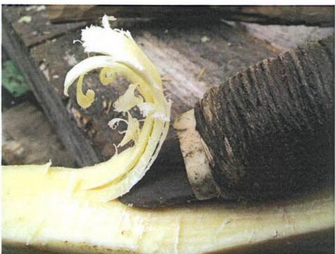
Рис. 153. Работа каменной стамеской по «свежему» бивню
