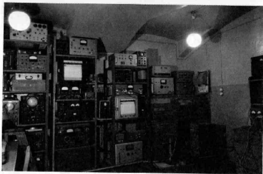
Рис. 10. Комплекс физических устройств для измерения активности радиоуглерода, 1967 г. — две установки с кюветами 3 и 10 мл
