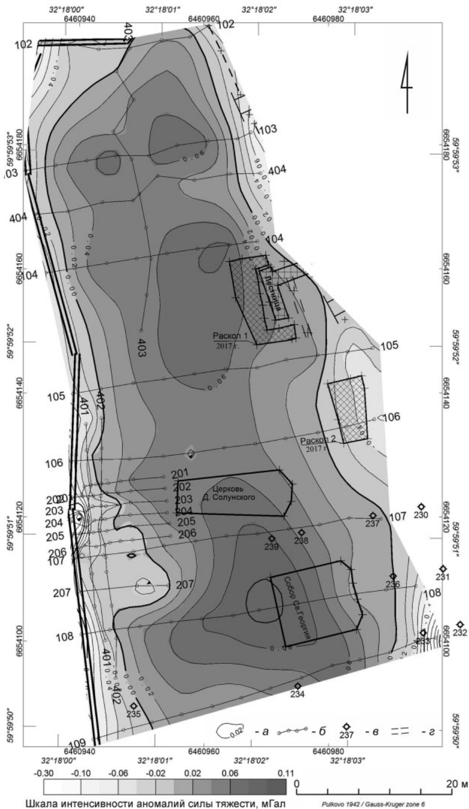
Рис. 2. Двор Ладожской крепости. Карта аномалий силы тяжести: a – изолинии аномалий силы тяжести; b – линии геофизических профилей; v – буровые скважины (1989 г.); z – фрагменты разрушенных крепостных стен
